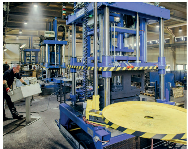
In der Niederdruckgießanlage werden qualitativ hochwertige und sicherheitsrelevante Bauteile (z. B. Fahrwerksteile) gegossen. Foto: LGL
