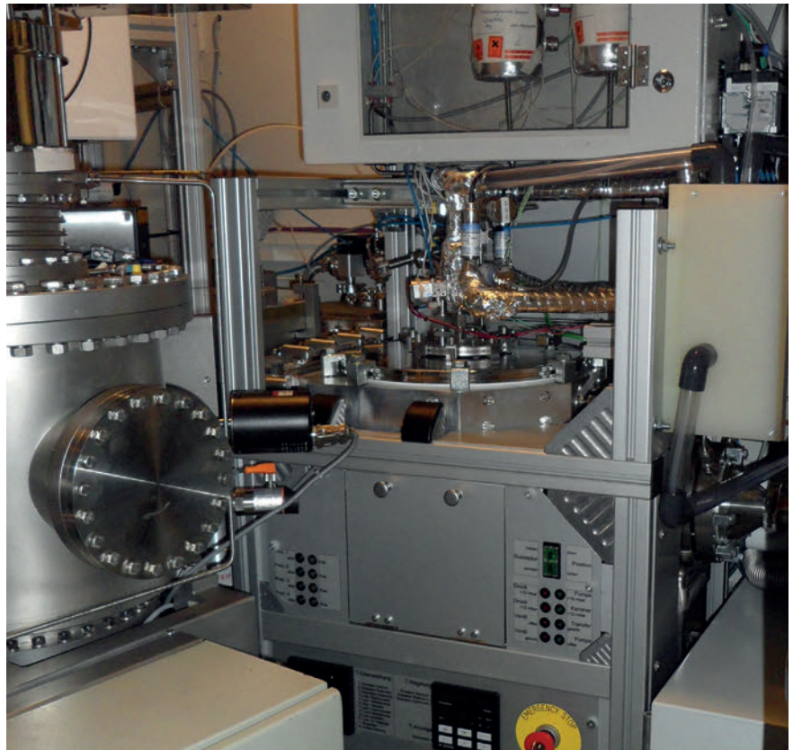
CALDERA – eine am Lehrstuhl für Halbleitertechnologie gebaute Anlage zur Atomlagenabscheidung. Foto: Dr. Bodo Kalkofen
